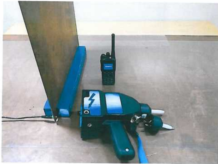
图三：静电放电抗扰度检测布置图
