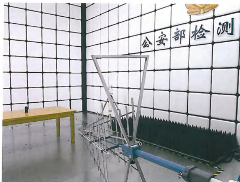
图七：辐射骚扰检测布置图（30MHz-1000MHz）
